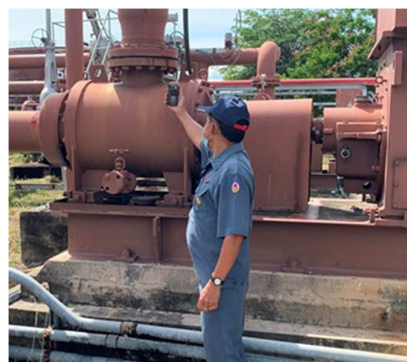
รูปที่ ข-13 การดำเนินการตรวจวัดไอน้ำมัน โดยใช้ Portable Gas Detector
